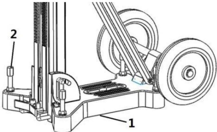
Установочные болты (2) служат для выравнивания платформы по уровню. Регулировка установочными болтами должна производиться вручную. Запрещается подтягивать установочные болты ключами.
