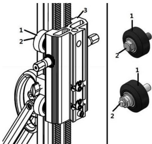
2. Подтянуть и отрегулировать ролики (2), до полного устранения люфта.
