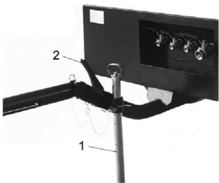
Рис. 3.1 Буксирная балка со стандартной опорной стойкой и тормозами
