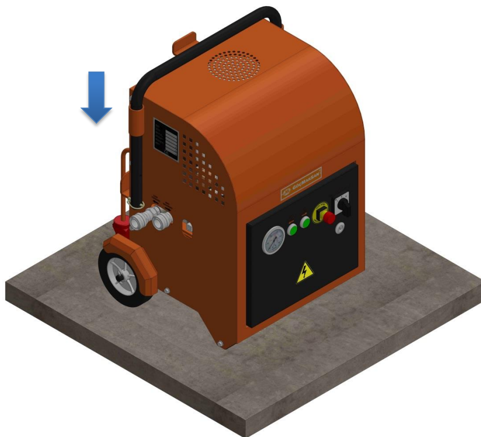
Рисунок 2. Выравнивание станка на твердом грунте
